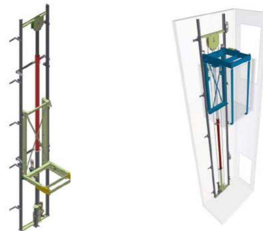
**SpaceQuby è possibile in doppia versione, sia con meccanica rucksack "a sedia" che Narrow "rovescia" a seconda delle portate. Questo per consentire sempre la minor fossa possibile e, quindi, il minor impatto sull'edificio.**
