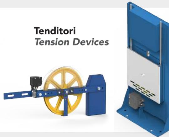
Gamma di tenditori orizzontali e verticali ad ingombro ridotto e diametro 200, 250 o 300 mm. I tenditori verticali si possono fissare al suolo. Sono completi di contrappeso in ghisa per utilizzo con limitatore mono o bidirezionale e protezione puleggia.
